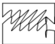
б. трещина вида 2
